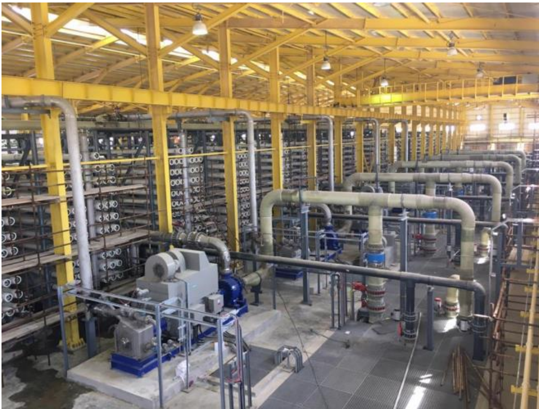
اسکیده‌های آب شیرین‌کن آب دریا با پمپ به توان ۲,۷ مگاوات و سیستم بازیافت انرژی از طریق توربین پلتون
